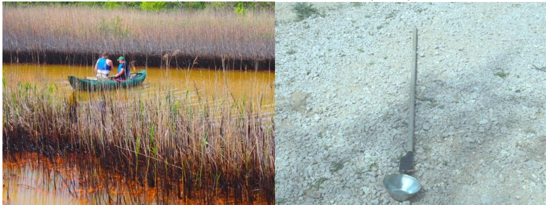
Slike 6. i 7. Uzorkovanje mulja i vode u laguni DIV-a – 26. 04. 2019. Dolje desno improvizirana oprema za uzorkovanje mulja i vode.
