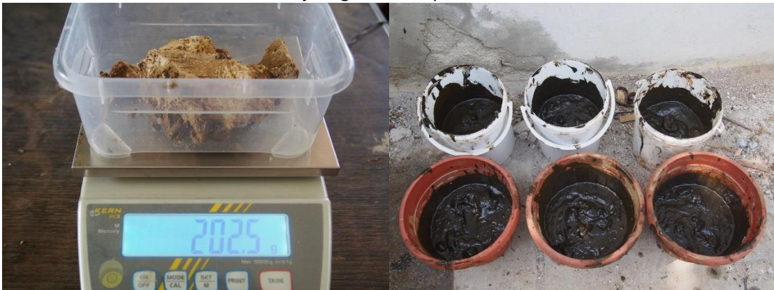
Slike 18. i 19. Odvage i priprema za miješanje mulja iz lagune i mulja iz gradskih otpadnih voda
