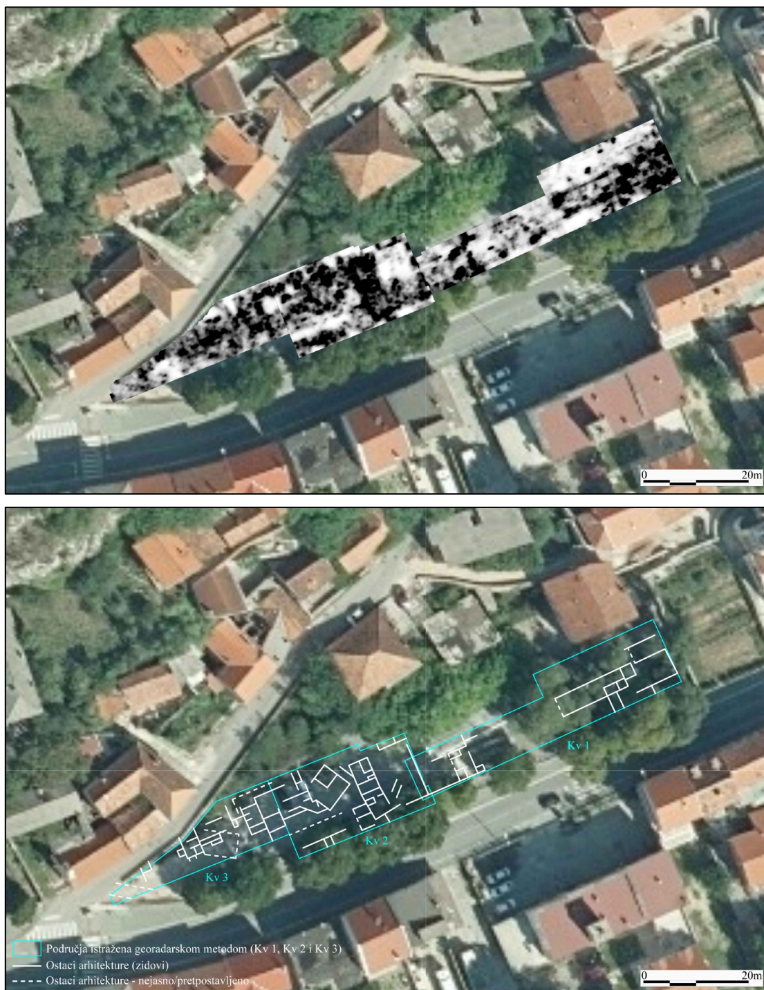
Slika 8. Knin – Stara tržnica . Georadarski signali na intervalu dubine 0,5– 0,8 m na aerofotografiji Državne geodetske uprave R. Hrvatske (gore). Bijele linije naznačavaju jake, usmjerene linearne georadarske anomalije koje predstavljaju odaziv ostataka arhitekture ispod današnje površine (dolje). Najzahtevniji uslovi za georadarsko istraživanje su bili na području Kv 1. Tome je nešto doprinjela ploča iz armiranog betona, koja prouzrukuje deformaciju georadarskih signala a nepovoljna okolnost je i povišena vlažnost na dubini ispod 0,5 m. Predpostavljamo, da na tom području nismo uspjeli sasvim jasno prepoznati svih ostataka arhitekture, pa ih može biti više od naznačenih na interpretaciji rezultata georadarskih istraživanja (vidi i slike 5-7 ).
