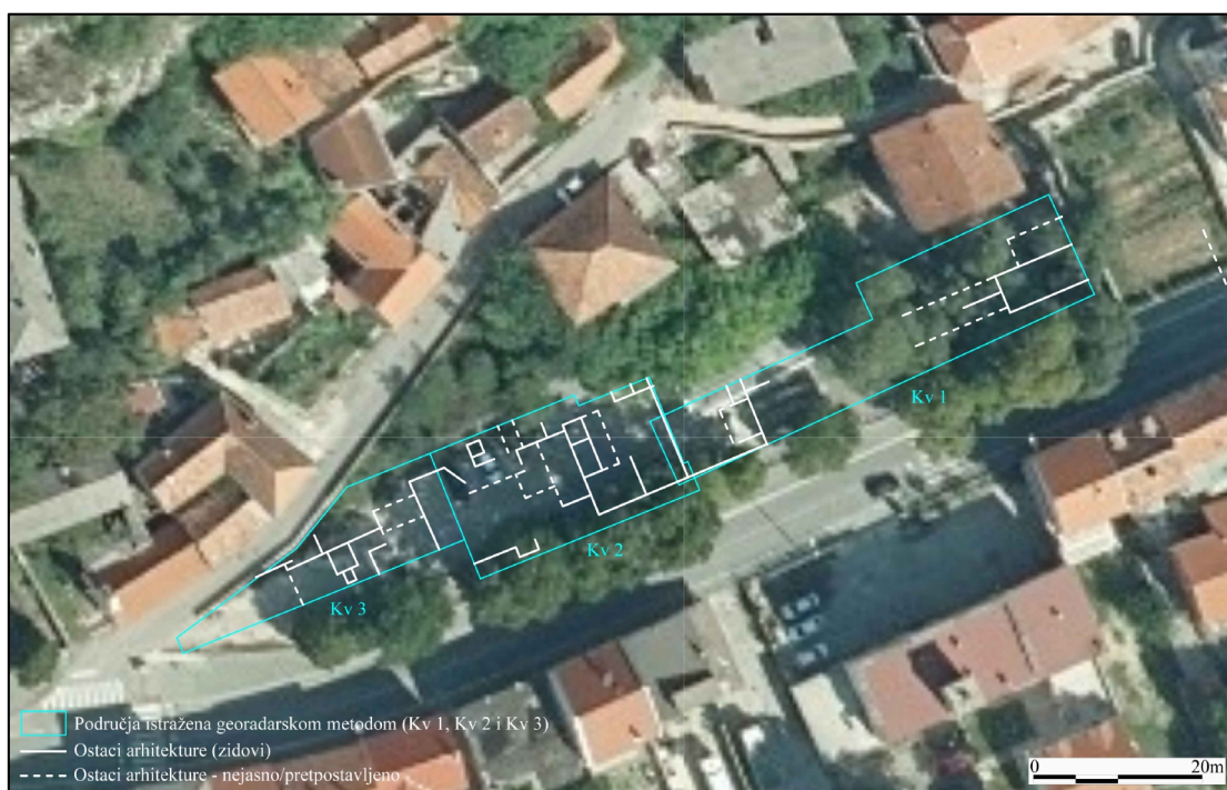
Slika 9. Knin – Stara tržnica . Georadarski signali na intervalu dubine 0,8– 1,1 m na aerofotografiji Državne geodetske uprave R. Hrvatske (gore). Bijele linije naznačavaju jake, usmjerene linearne georadarske anomalije koje predstavljaju odziv ostataka arhitekture ispod današnje površine (dolje). Najzahtevniji uslovi za georadarsko istraživanje su bili na području Kv 1. Tome je nešto doprinjela ploča iz armiranog betona, koja prouzrukuje deformaciju georadarskih signala a nepovoljna okolnost je i povišena vlažnost na dubini ispod 0,5 m. Predpostavljamo, da na tom području nismo uspjeli sasvim jasno prepoznati svih ostataka arhitekture, pa ih može biti više od naznačenih na interpretaciji rezultata georadarskih istraživanja (vidi i slike 5-7 ).
