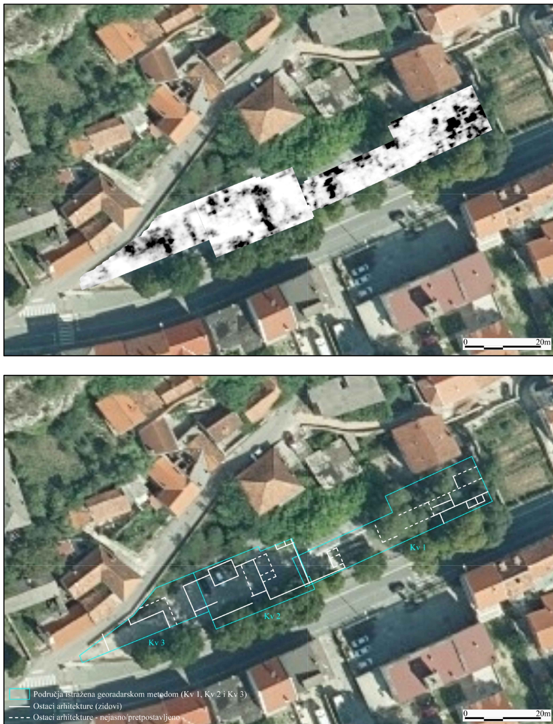
Slika 11. Knin – Stara tržnica . Georadarski signali na intervalu dubine 1,3– 1,6 m na aerofotografiji Državne geodetske uprave R. Hrvatske (gore). Bijele linije naznačavaju jake, usmjerene linearne georadarske anomalije koje predstavljaju odziv ostataka arhitekture ispod današnje površine (dolje). Najzahtevniji uslovi za georadarsko istraživanje su bili na području Kv 1. Tome je nešto doprinjela ploča iz armiranog betona, koja prouzrukuje deformaciju georadarskih signala a nepovoljna okolnost je i povišena vlažnost na dubini ispod 0,5 m. Predpostavljamo, da na tom području nismo uspjeli sasvim jasno prepoznati svih ostataka arhitekture, pa ih može biti više od naznačenih na interpretaciji rezultata georadarskih istraživanja (vidi i slike 5-7).
