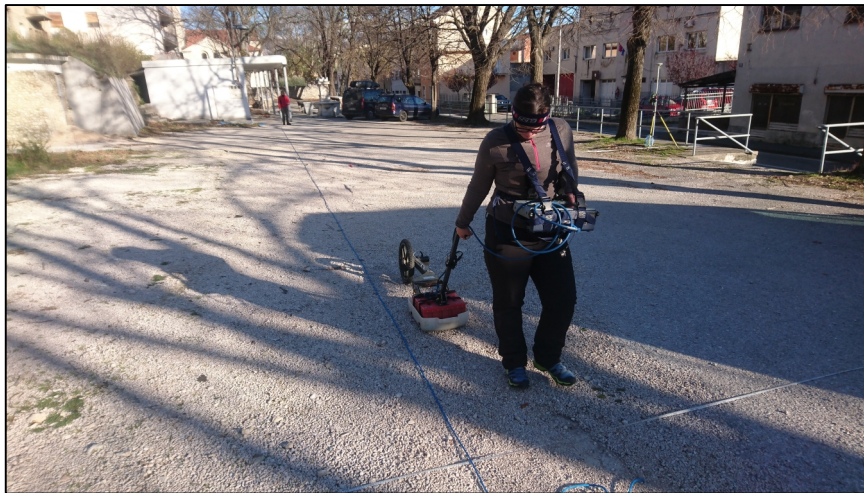
Slika 4. Snimanje georadarom GSSI SIR3000 sa 400 MHz antenom na zapadnom dijelu Stare tržnice u Kninu (foto: B. Mušič).
