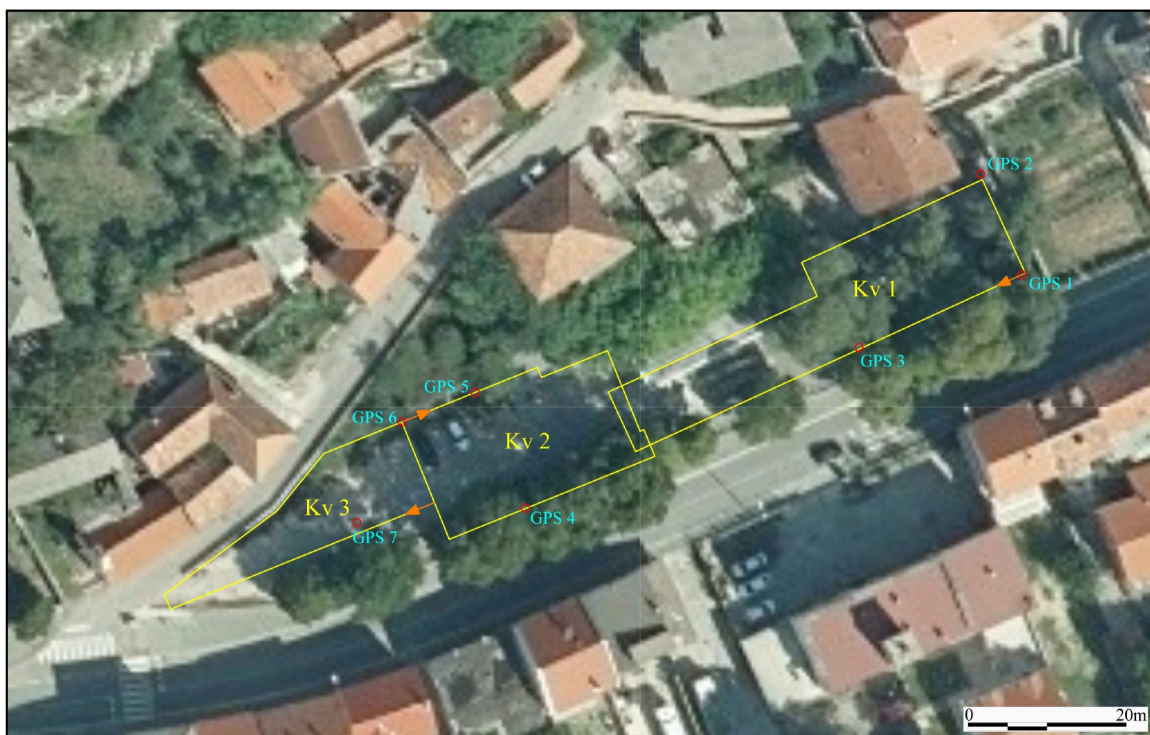
Slika 3. Knin - Stara tržnica. Površina u iznosu 1.250 m 2 (Kv 1, 2 i 3) istražena georadarskom metodom i 7 referenčnih točak snimljenih sa GPS uređajem na aerofotografiji Državne geodetske uprave RH.
