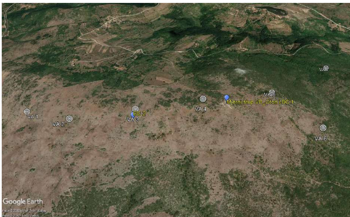
Grafički prikaz F-2 Prikaz rasporeda vjetroagregata (VA 1 – VA 7), mjernog stupa i batcordera na lokaciji VE Oton (BC = batcorderi)
