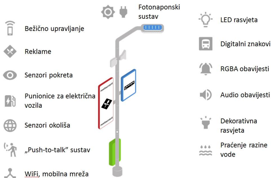
Slika 8 Mogućnosti iskorištavanja infrastrukture javne rasvjete
